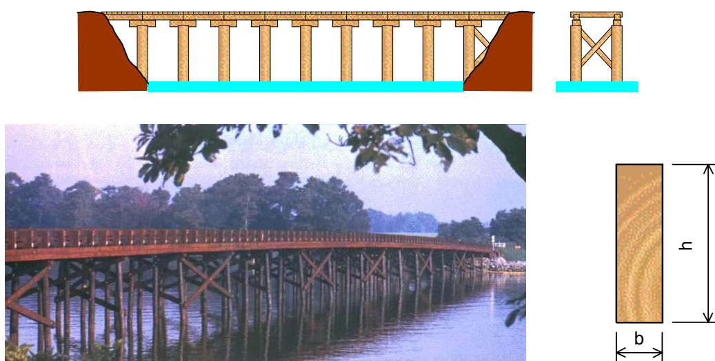
Figura 4.3 -Vigas de peças serradas
