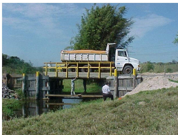
Figura A31 – Prova de carga na ponte
