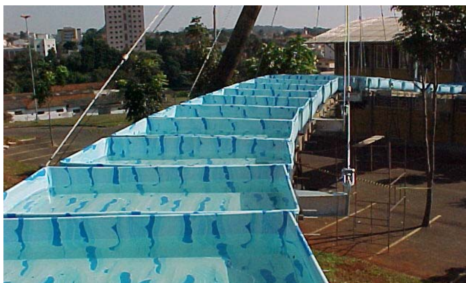
Figura A45 – Prova de carga da passarela
